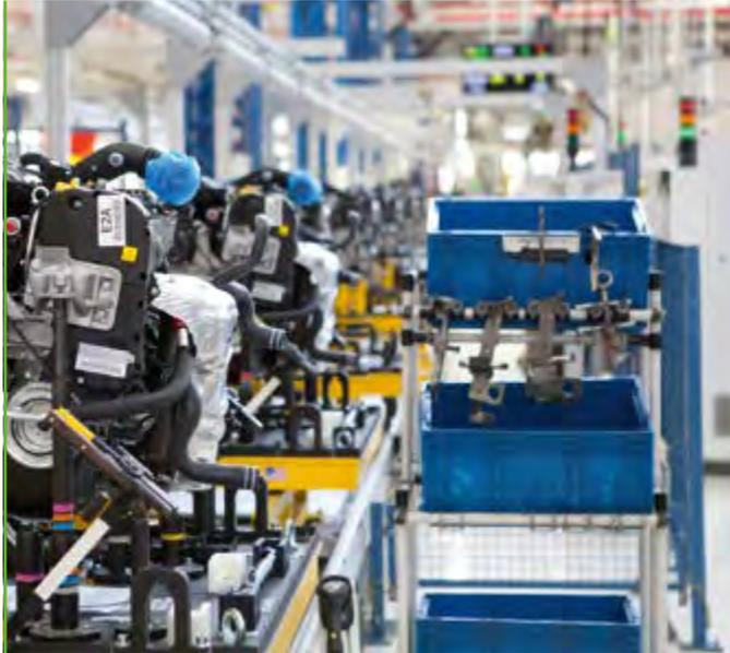
Die VDA-KLT-Behälterserien sind speziell auf die Logistikprozesse in der Automobilindustrie zugeschnitten. Die genormten Behälter werden ausschließlich aus PP-Copo hergestellt, sind extrem belastbar, UV-stabil, waschprozess- und reinigungsbeständig.
